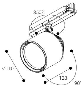
Proyectores iluminación: Aqa. Fabricado enteramente en aluminio para una mejor disipación del calor. Lacado con resinas epoxi-poliéster mediante aplicación electrostática y posterior polimerización, resistente a los rayos UV y a la corrosión. Reflector en policarbonato metalizado. Difusor: Cristal Transparente. Acabado: Negro.
