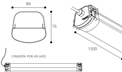
Iluminación industrial: Hermetic Line. Luminaria estanca (IP66) fabricada en policarbonato gris con difusor opalino. Resistente a los rayos UV, a la corrosión y al agua. Difusor: Policarbonato opal. Acabado: Gris.
