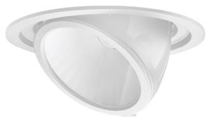
Downlights Empotrables: Dorfin. Disipador y marco fabricados en fundición de aluminio lacados con resinas epoxi-poliéster de alto rendimiento mediante aplicación electrostática y posterior polimerizado. Resistente a los rayos UV y a la corrosión. Reflector de plástico técnico de muy alta reflexión Difusor: Cristal Transparente. Acabado: Blanco.
