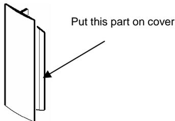
Le joint de couvercle se glisse et se positionne sur l'extrémité d'un couvercle, l'autre côté reste disponible pour réouverture
