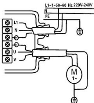
Esquema de cableado para conectar bombas monofásicas de 230 V de más de 1,1 kW (1,5 CV) a través de un contactor de maniobra. / *Wiring diagram to connect 230 V single-phase pumps over 1.1 kW (1.5 HP) through a contactor switching.*
