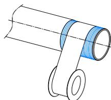
7. Segundo paso en el apriete: La válvula se mantiene fija y es el tubo el que gira.
