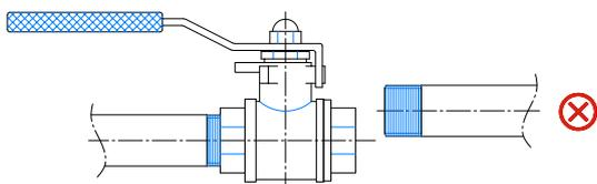
8. Debido a que normalmente la longitud de la rosca del tubo es mayor que la de la válvula, es indispensable para evitar roturas de la válvula que el extremo del tubo nunca llegue a tocar el fondo de la rosca de la válvula. Mínimo 1 mm.
