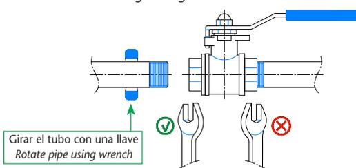
4. Revisar la alineación de las tuberías. La válvula no absorbe las diferencias. Las distorsiones resultantes de una incorrecta alineación pueden causar problemas de sellado, dificultades al maniobrar y hasta roturas.
