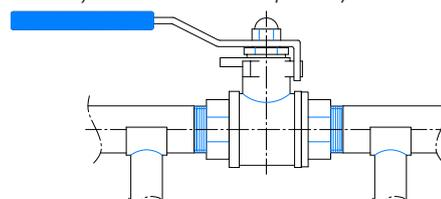
NOTA IMPORTANTE: El diseño de la instalación debe evitar todo tipo de tensiones para no dañar a la válvula y mantenerla operativa en todo momento.
