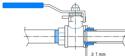
5. No apretar nunca una válvula en un tornillo de banco, ni usar extensiones de llave. Podrían causar roturas o deformaciones en la válvula. A la hora de unir el tubo y la válvula, la llave fija o inglesa debe colocarse en el hexágono del lado correcto de la válvula, no utilizar otro tipo de llave. De forma general, no sobrepasar un par de apriete de 30 Nm.
