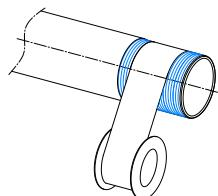
4. Revisar la alineación de las tuberías. La válvula no absorbe las diferencias. Las distorsiones resultantes de una incorrecta alineación pueden causar problemas de sellado, dificultades al maniobrar y hasta roturas.
