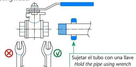
7. Segundo paso en el apriete: La válvula se mantiene fija y es el tubo el que gira.
