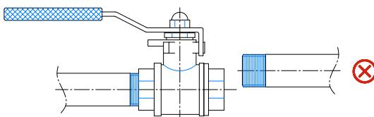
5. No apretar nunca una válvula en un tornillo de banco, ni usar extensiones de llave. Podrían causar roturas o deformaciones en la válvula.
